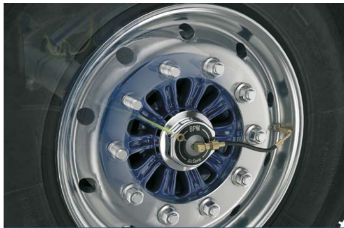
BPW oferuje producentom pojazdów system AirSave, który potrafi sam dopompować powietrze w oponach w czasie jazdy.
